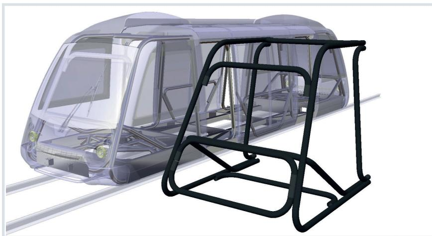
**Bild 1.** Spaceframe für ein Stadtbahn-Frontend aus Flechtrohren: Um das Gewicht zu reduzieren, wurden umfassende Änderungen an der Geometrie vorgenommen © Far UK
